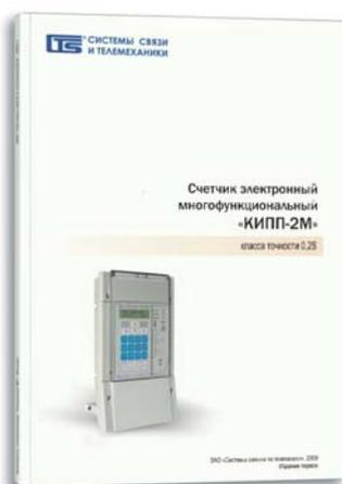
«КИПП-2М» объединяет в себе функции интеллектуального измерительного преобразователя электрических величин класса 0,2, счетчика электроэнергии класса 0,2S, прибора для измерения показателей качества электроэнергии по ГОСТ 13109-97 и устройства телемеханики по ГОСТ 26.205-88 (10 или 16 ТС, 2 Ту).
