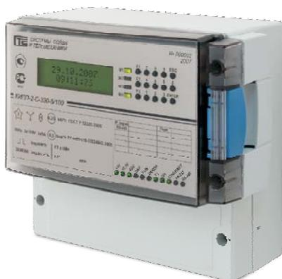
Счетчики «КИПП-2» сочетают в себе функции многотарифного счетчика высокого класса точности 0,2S и измерительного преобразователя, обеспечивающего быстрые измерения электрических параметров, в т.ч. и показателей качества электроэнергии.
