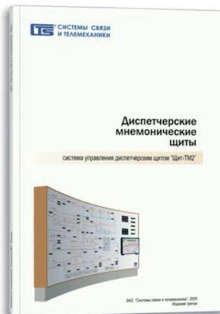
Диспетчерские щиты на основе мозаичной панели Mauell и оригинальной несущей конструкции, оборудованные современной системой управления «Щит-ТМ2», в состав которой входят: высокоскоростные щитовые контроллеры, разнообразные элементы индикации и ПО с открытыми стандартами взаимодействия.
